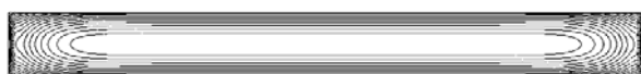
شکل (۱۷): کانتور شدت اغتشاش برای Ri = 10 و مدل اغتشاش RNG k - \epsilon
