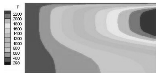
شکل (۷): کانتور دمای شعله برگشته نزدیک دیواره در مرز بین دو ناحیه بالادستی و ناحیه پایین دستی برای زمان t = 0.09 \text{ msec}
