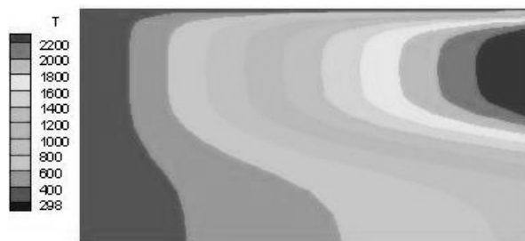
شکل (۵): کانتور دما در مرز بین ناحیه بالادستی و ناحیه پایین دستی نزدیک دیواره (اعتبار سنجی شده با Lee and Tien [12])
