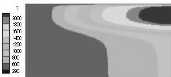
شکل (۹): کانتور دمای شعله برگشته نزدیک دیواره در مرز بین دو ناحیه بالادستی و ناحیه پایین دستی برای زمان t = 0.07 \text{ msec}
