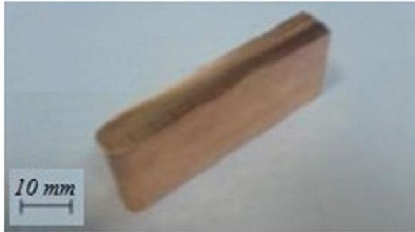
Fig. 2 Die sink EDM tool
